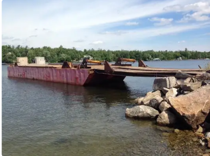
1990 60 'x 16' x 6' Stahldeckkahn mit Rampen, Spud-Brunnen und Spuds
